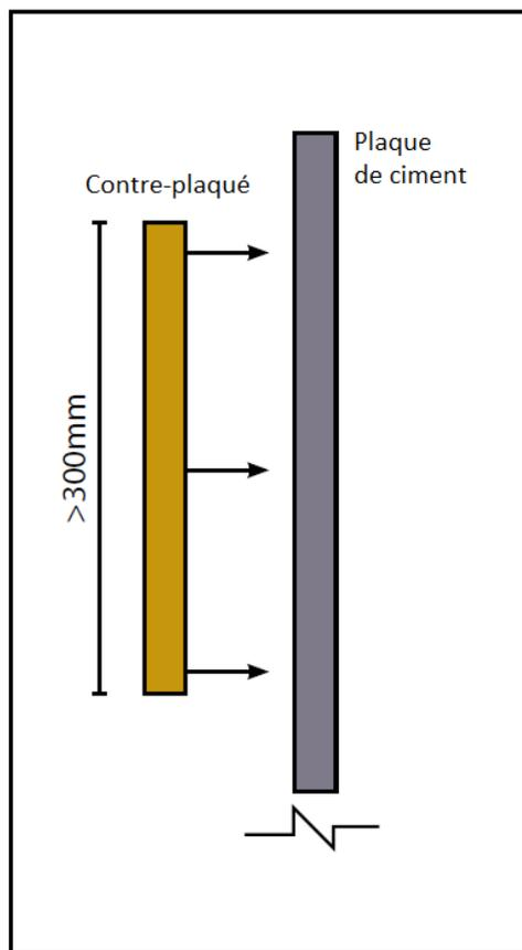
Si la paroi de votre hammam est composée d'une plaque en ciment, fixez-lui au dos un carré de minimum 300-300mm de contre-plaqué afin de maintenir le protecteur en place. En effet, la plaque de ciment ne sera pas assez résistante pour maintenir les vis et le protecteur.
