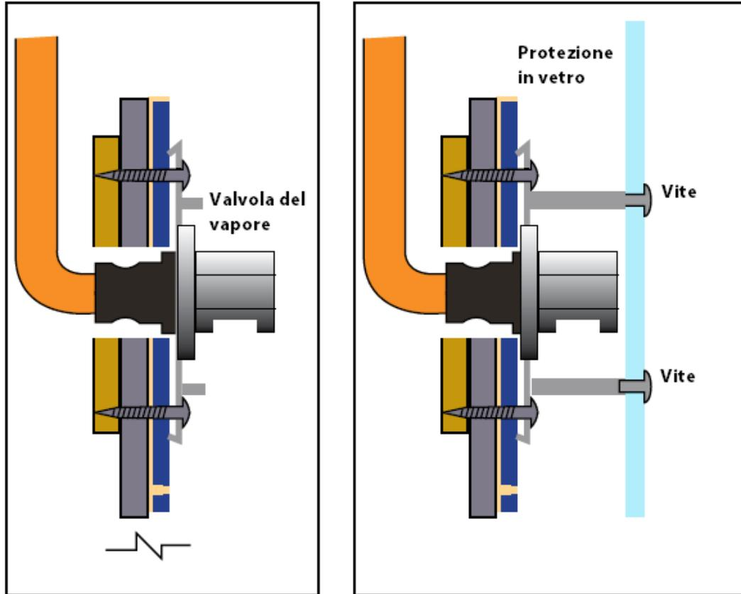
Avvitare la valvola di uscita del vapore sulla estremità sporgente del tubo di ingresso del vapore.
