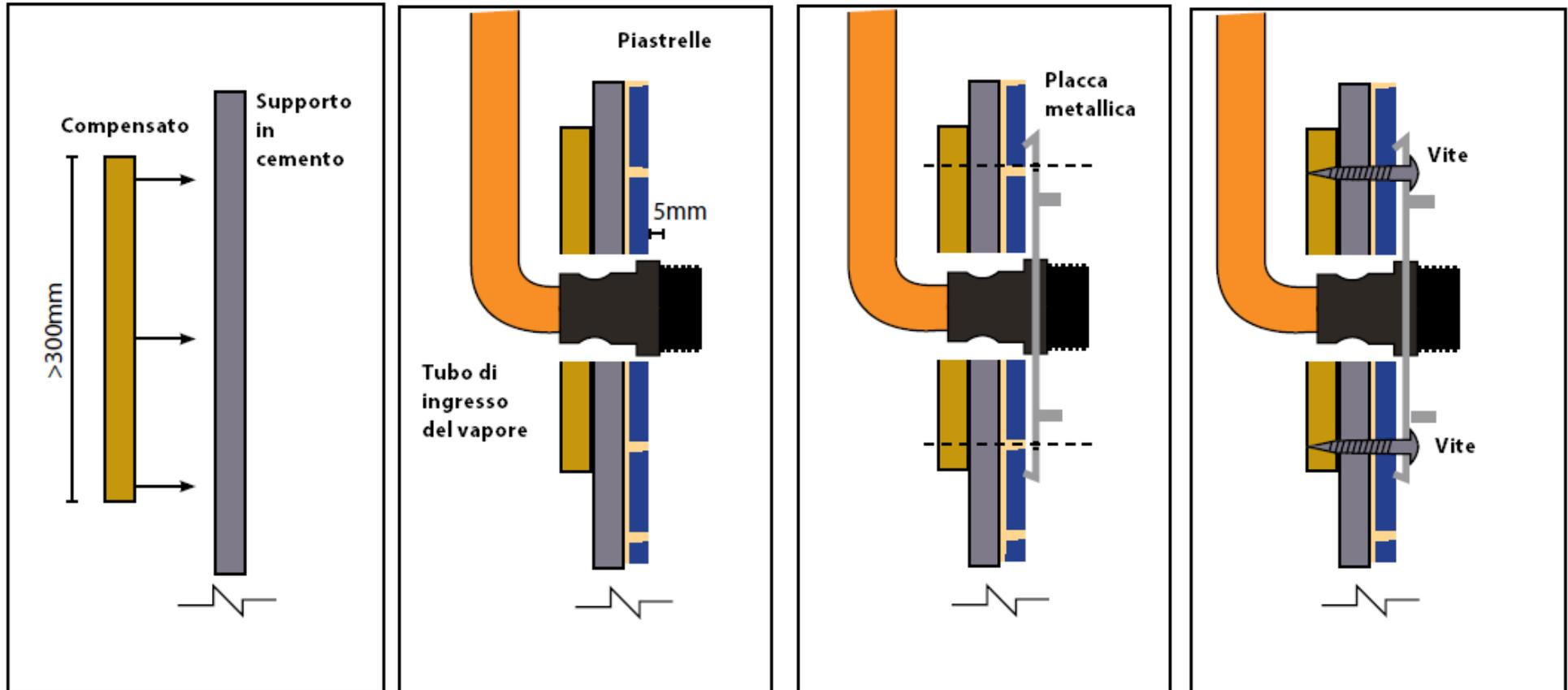
Se avete un supporto in cemento per il bagno turco, fissate un quadrato di compensato maggiore di 300x300mm dietro al supporto in modo da poter fissare la protezione. Il supporto in cemento non sarà sufficientemente forte per sostenere le viti.
