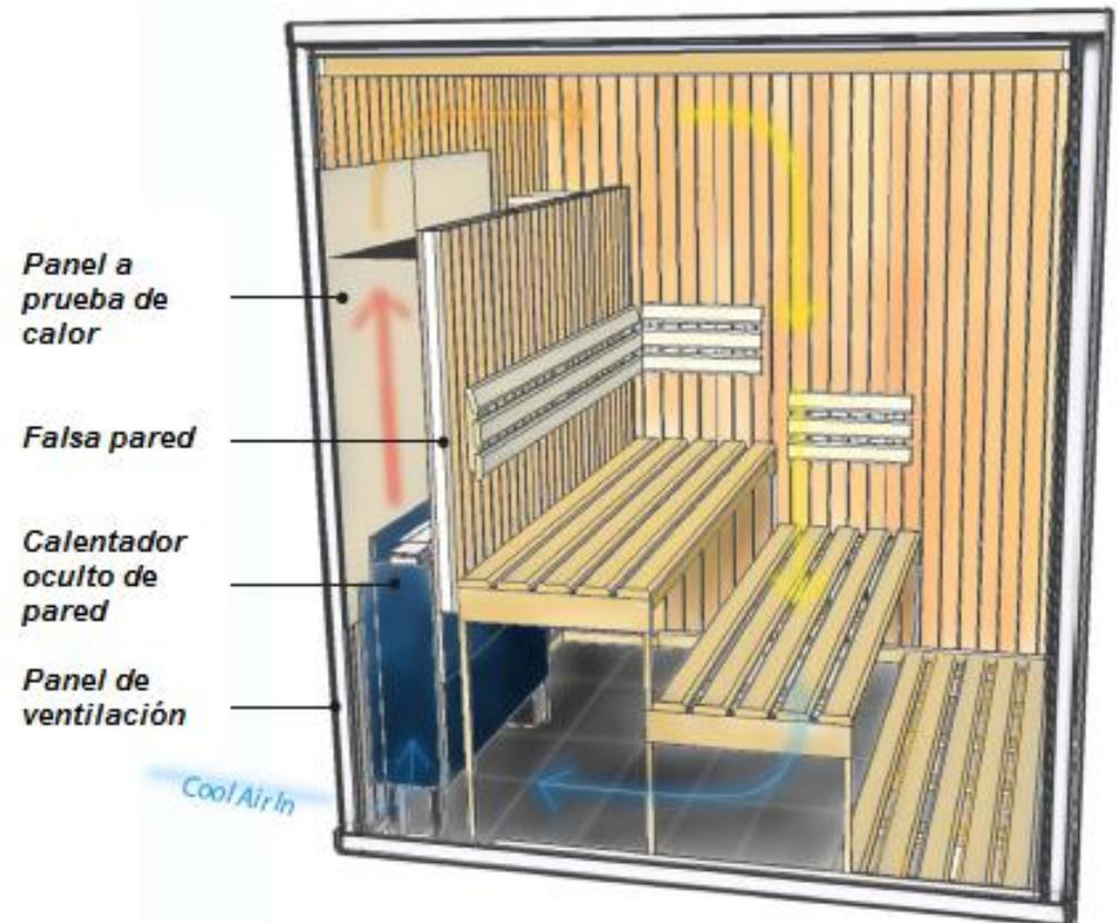
*Sección de una cabina Heavy Duty*
